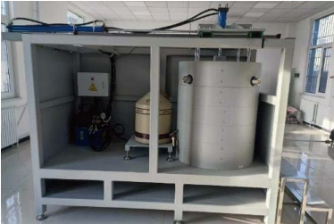
反宇宙射线 HPGe \gamma 能谱仪
